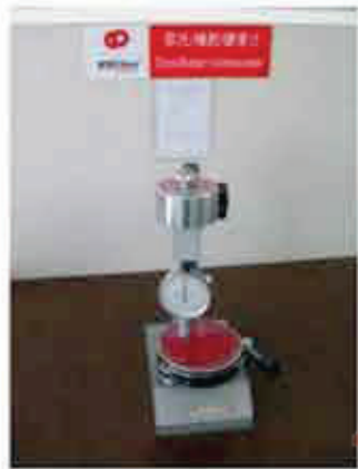
Твердомер Шора (проверка твердости резины)
