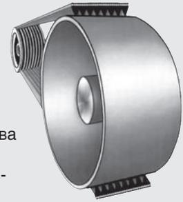
Плоский шкив должен быть цилиндрическим. При переходе на плоско-клиновой привод необходимо проверить высоту округления рабочей (скользящей) поверхности применяемого ранее плоского шкива.
