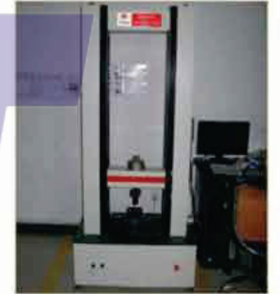
50 кН установка для испытаний на выдавливании
