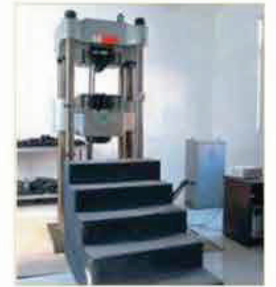
200 кН установка для испытаний прочности материалов на разрыв
