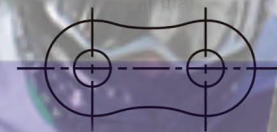
Форма соединительной пластины с расширенной средней частью
