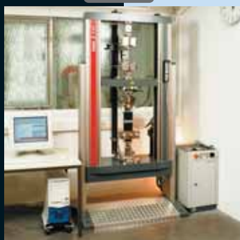
Контроль проволоки и соединителей на современной испытательной машине при изменяемой нагрузке и растяжении
