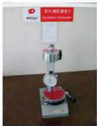
Твердомер Шора (проверка твердости резины)
