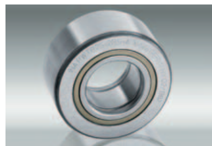
Устойчивые к износу опорные ролики с оптимизированным профилем наружного кольца меньше изнашивают ответную дорожку качения
