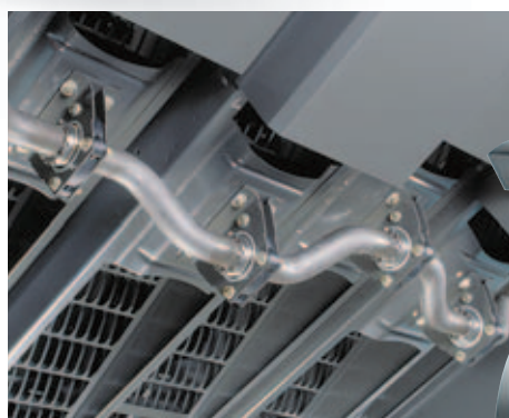
Жесткость к опрокидывающему моменту и компактность: подшипник INA с четырехточечным контактом в соломотрясе комбайна
