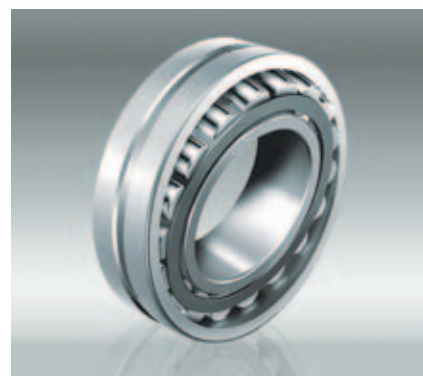
Для самых тяжелых нагрузок: сферические роликоподшипники воспринимают высокие радиальные и двусторонние осевые нагрузки
