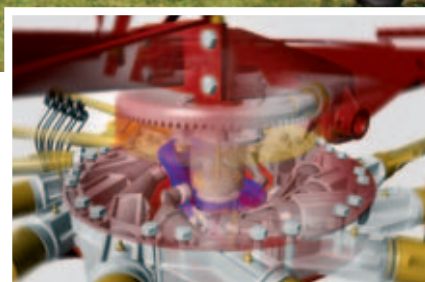
Опорные ролики INA в узле регулирования положения сегментов ротора вносят вклад в надежность и долговечность работы ворошилки (Фото: FELLA)
